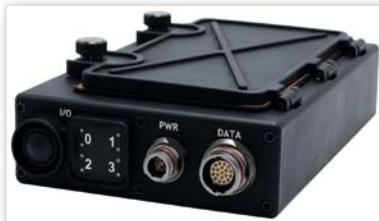
*El Mini-SCCv1.1 proporciona audio de conexión cruzada entre múltiples redes de radio diferentes, independientemente del tipo de radio, frecuencia o clave de cifrado.*
