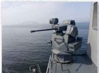
SENTINEL 30 es una estación remota de armas estabilizada para armas de 30 y 40mm. El sistema puede ser operado de día y de noche en misiones de vigilancia y combate.
